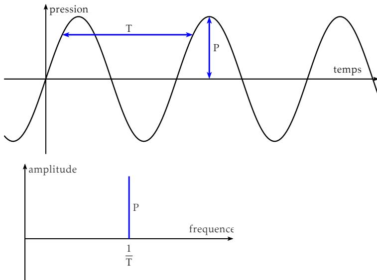
En 1822, Joseph Fourier montre que tout signal périodique de fréquence  $f_0$  peut être décomposé en une somme de signaux sinusoïdaux de fréquence  $f_n$  multiples de  $f_0$  :  $f_n = n \times f_0$ .
